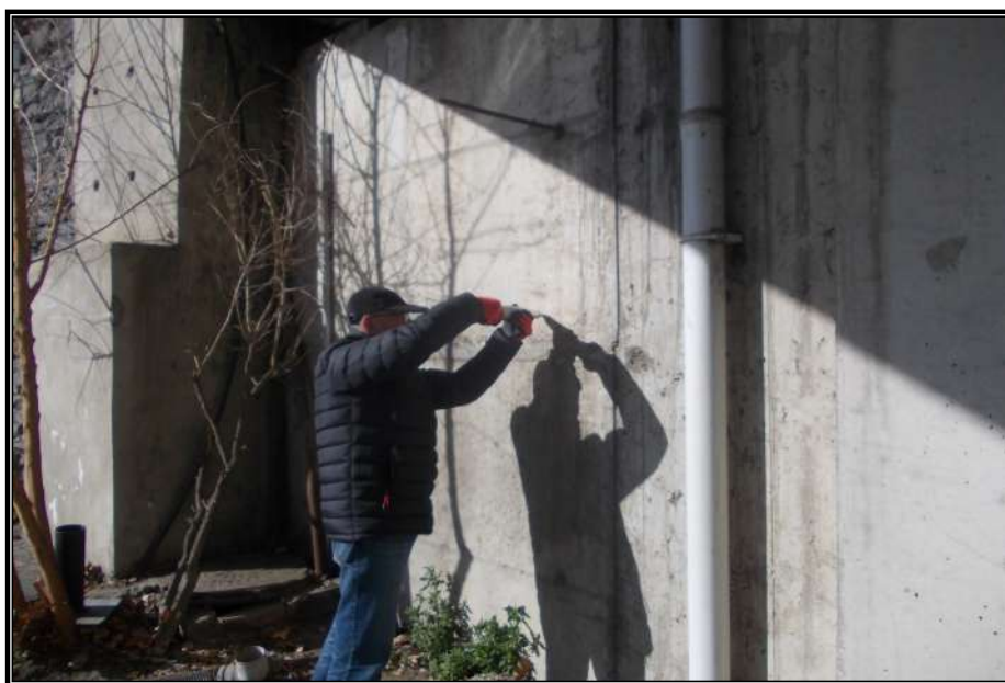
ფოტო 14. ბეტონის კლასის დადგენა Elkometer181 -ის ჩაქუჩით
